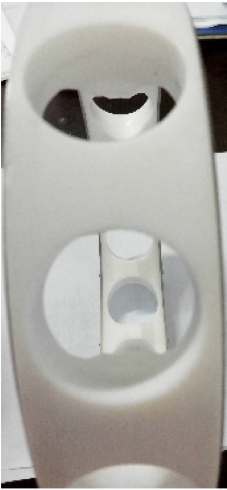
(c) 试验后改进轴承的保持架外观
